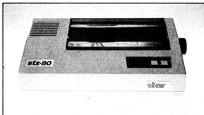
Bild 8. Star STX 80, ein leistungsfähiger Thermodrucker
