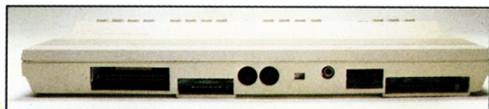
Bild 2. Der PC 128 von hinten gesehen. Von rechts nach links: User-Port, RGB-Ausgang, Fernseher, Composite, Video, Serieller Port, Datasetten-Anschluß, Expansions-Port für Steckmodule
