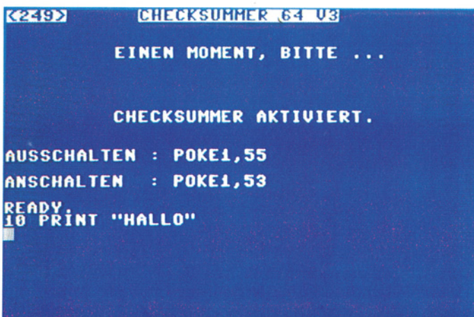
»Checksummer«, die Eingabehilfe für Basic-Programme. Links oben sehen Sie die Prüfsumme für die Programmzeile unten.
