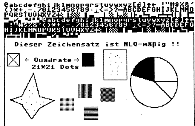
Bild 1. Hardcopy mit dem Star NL-10. Ein Kreis auf dem Bildschirm entspricht exakt einem Kreis auf dem Papier.
