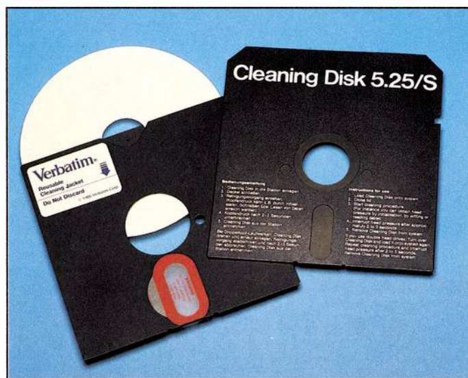
Bild 2. So sehen Reinigungsdisketten verschiedener Systeme aus
