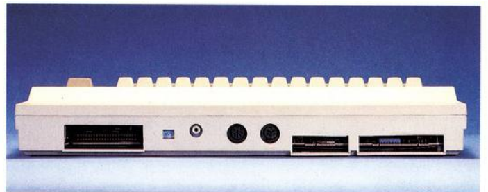
Bild 3. Die Rückseite beherbergt den Expansionsport, den Fernsehanschluß mit Reglern, die Video-Buchse, den seriellen Bus, den Kassettenanschluß und den User-Port. Es gibt keine Probleme beim Anschluß der gesamten Commodore-Peripherie.
