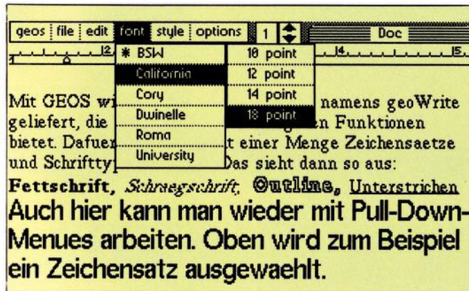
Bild 13. Die Textverarbeitung geoWrite arbeitet ebenfalls mit hochauflösender Grafik. So können viele verschiedene Zeichensätze und Schrifttypen eingestellt und am Bildschirm auch betrachtet werden. Einige wenige Befehle befinden sich in den Pull-Down-Menüs. Unter der Menüleiste ist die Formatzeile, auf der die Textträger und die Tabulatoren eingestellt werden können.
