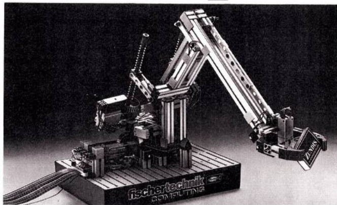
Der Trainings-Roboter als fischertechnik computing Bausatz – besonders leistungsfähig durch drei simultan gesteuerte Bewegungsachsen.
