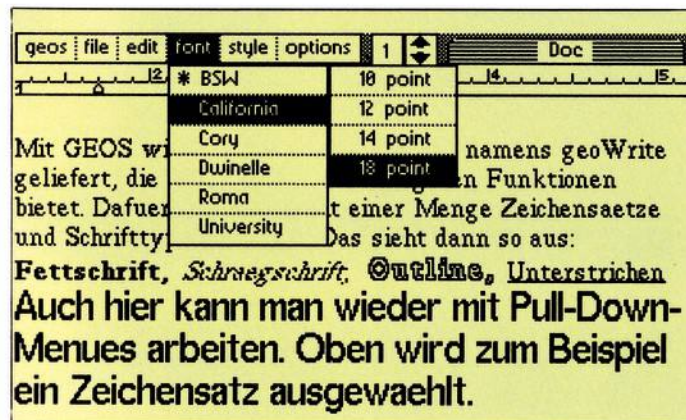
Bild 13. Die Textverarbeitung geoWrite arbeitet ebenfalls mit hochauflösender Grafik. So können viele verschiedene Zeichensätze und Schrifttypen eingestellt und am Bildschirm auch betrachtet werden. Einige wenige Befehle befinden sich in den Pull-Down-Menüs. Unter der Menüleiste ist die Formatzeile, auf der die Textränder und die Tabulatoren eingestellt werden können.
