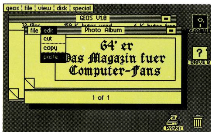
Bild 9. Mit dem eingebauten Fotoalbum ist es möglich, Bilder aus Grafikprogrammen »herauszuschneiden« und bei Bedarf an anderer Stelle wieder zu verwenden.
