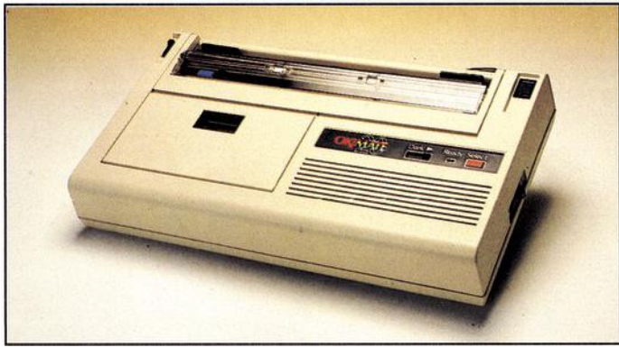
Bild 1. Der Okimate 20. Ein kleiner und farbiger Thermo-Transferdrucker
