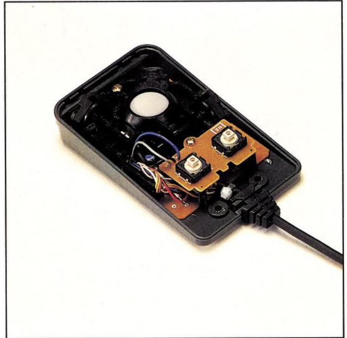
Bild 3. Die NCE-Maus (Gehäusedeckel abgeschraubt)
