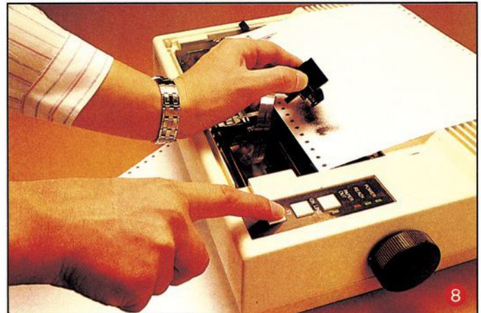
Achter Schritt: Der Selbsttest des Druckers schleudert den Dreck aus dem Druckkopf.
