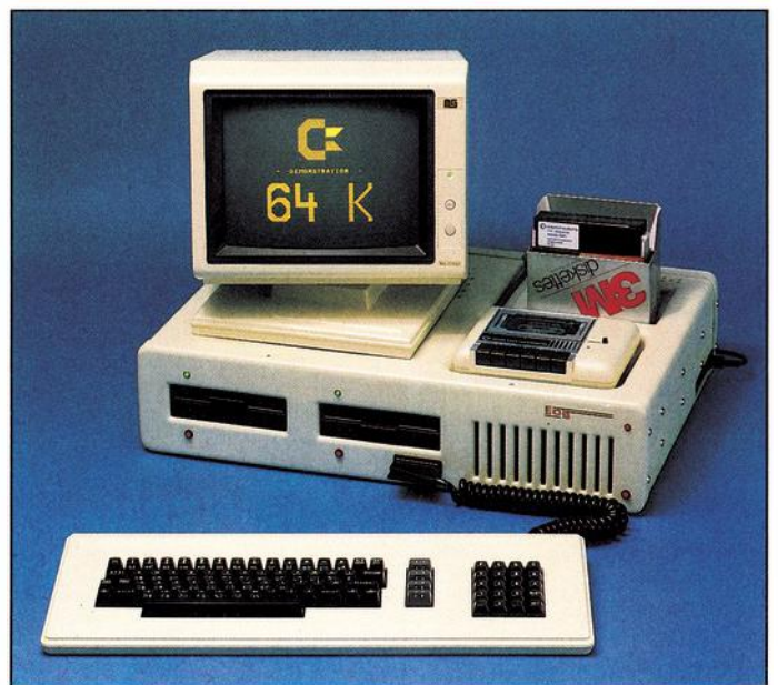
Alles in einem Gehäuse. Der Zusammenbau soll ohne Lötarbeiten möglich sein. Damit ist Schluß mit dem Kabelsalat.
