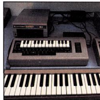
Bild 2. Mit dieser Zusatztastatur und einem Modul im Expansion-Port wird der C 64 fast zur professionellen Heimorgel
