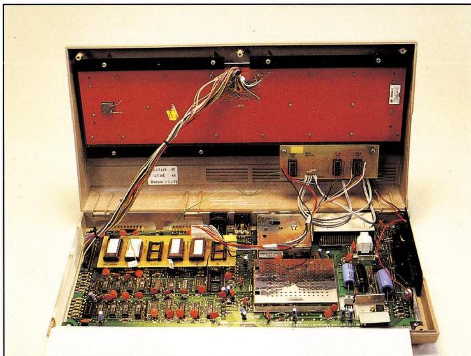
Bild 6. So wird EPROM-Trans in den C 64 eingebaut
