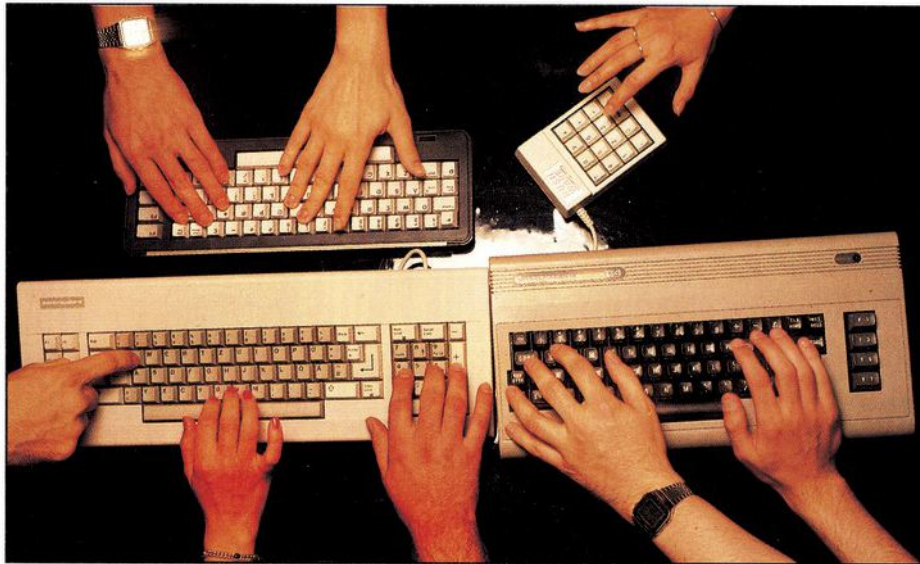
Zusatztastaturen von verschiedenen Computern lassen sich über den Joystick-Port an den C 64 anschließen. (Oben rechts die Zehnertastatur von Rushware.)
