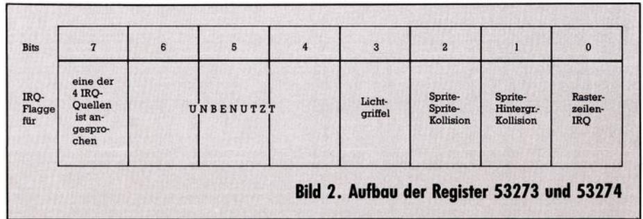
**Bild 2. Aufbau der Register 53273 und 53274**
