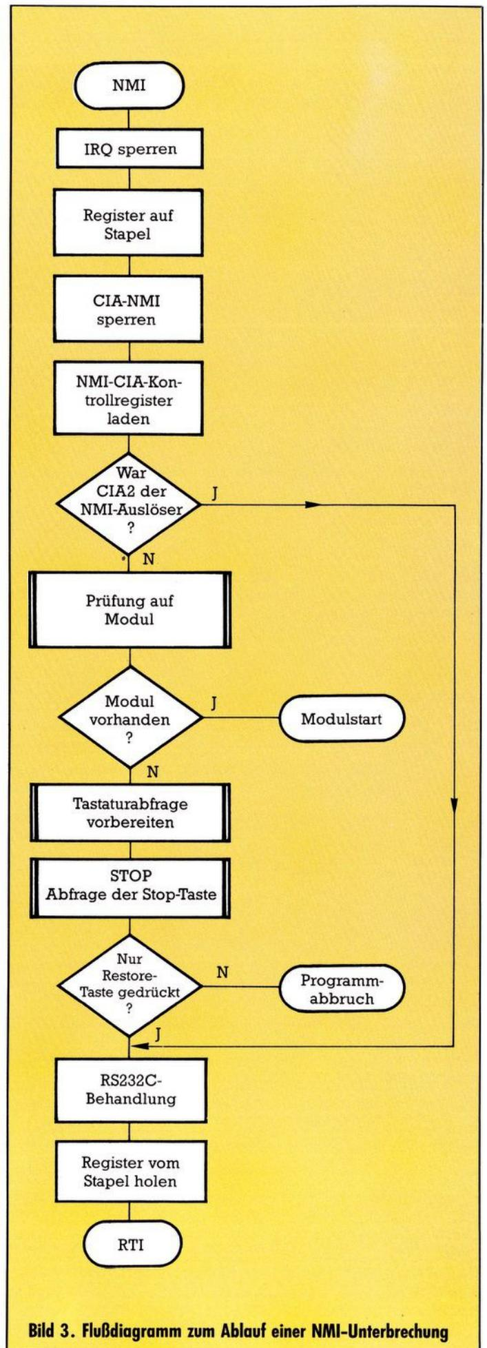
**Bild 3. Flußdiagramm zum Ablauf einer NMI-Unterbrechung**
