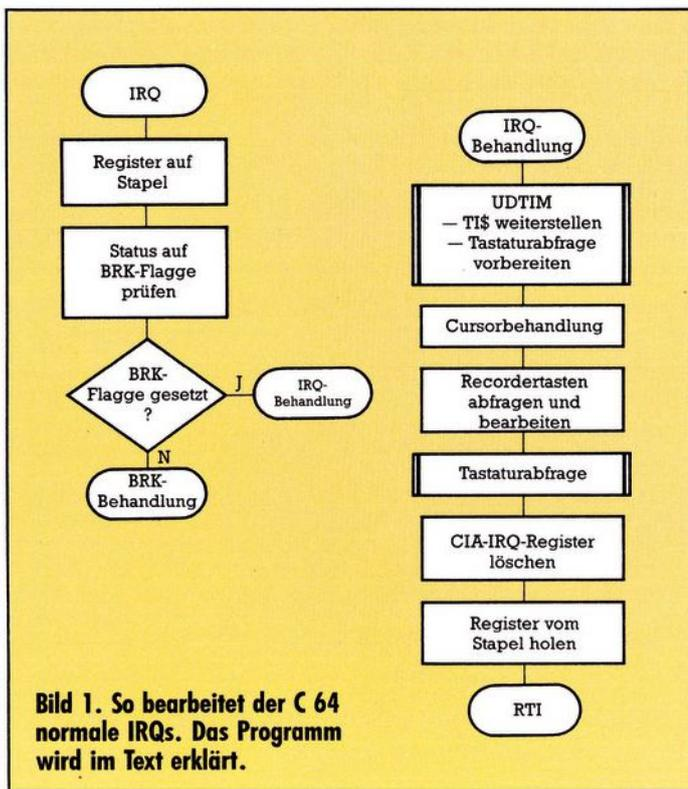
Bild 1. So bearbeitet der C 64 normale IRQs. Das Programm wird im Text erklärt.
