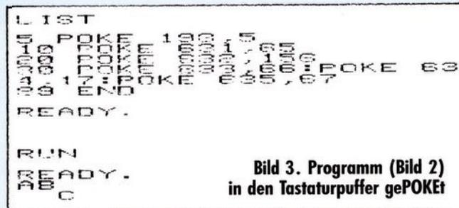
Bild 3. Programm (Bild 2) in den Tastaturpuffer gePOKEt
