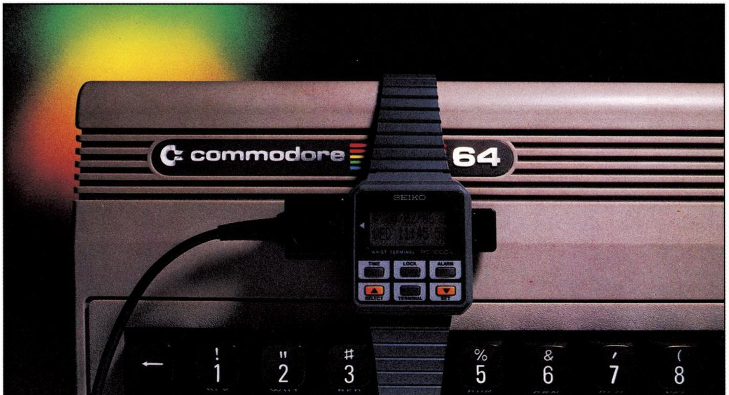
**E**s gibt mittlerweile Uhren, die von einem Computer, hier der C 64, mit Daten gefüttert werden können.
