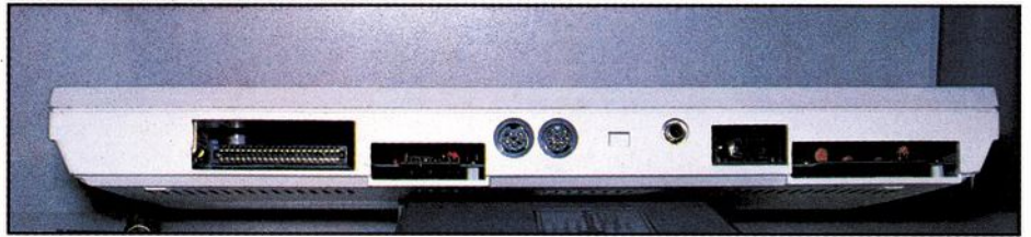
Bild 3: Die Rückseite des PC 128. Von rechts nach links: User-Port, RGB-Ausgang, Fernseher, Composite Video, serieller Port, Datasetten-Anschluß, Expansion-Port für Module.
