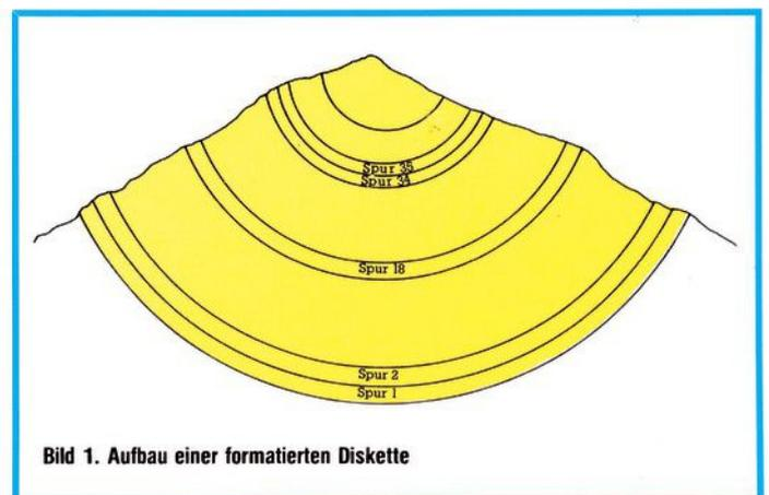
Bild 1. Aufbau einer formatierten Diskette
