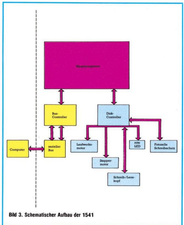
Bild 3. Schematischer Aufbau der 1541
