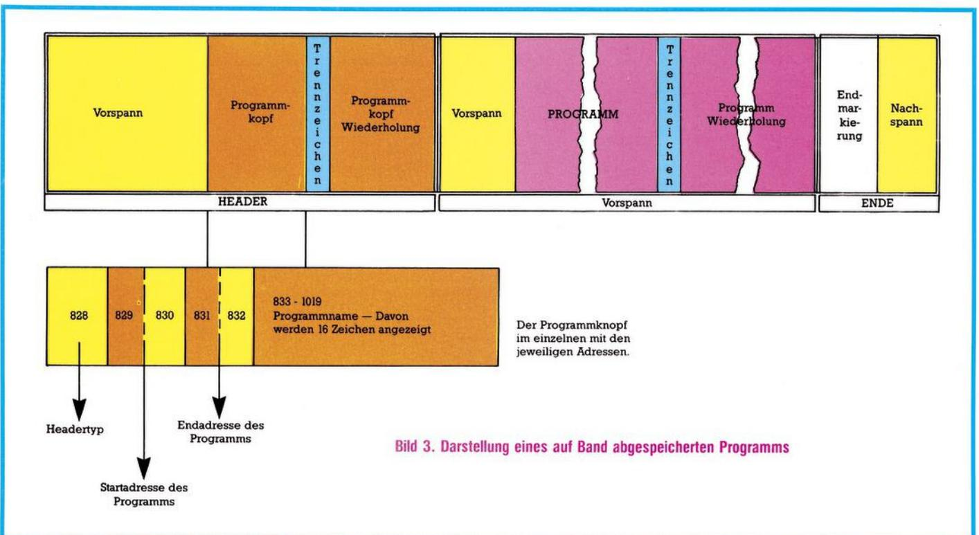
Bild 3. Darstellung eines auf Band abgespeicherten Programms
