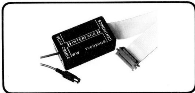
Das neue Druckerinterface Typ 92008 erlaubt, normale Drucker mit Centronics-kompatiblen Eingang an VC 20- und C 64-Computer anzuschließen. Der 8 KByte große Pufferspeicher bewirkt eine deutliche Erhöhung der Arbeitsgeschwindigkeit — Sie können nun gleichzeitig drucken und weiterrechnen. Das Interface ist für 298,— DM inkl. MwSt. sofort lieferbar.
