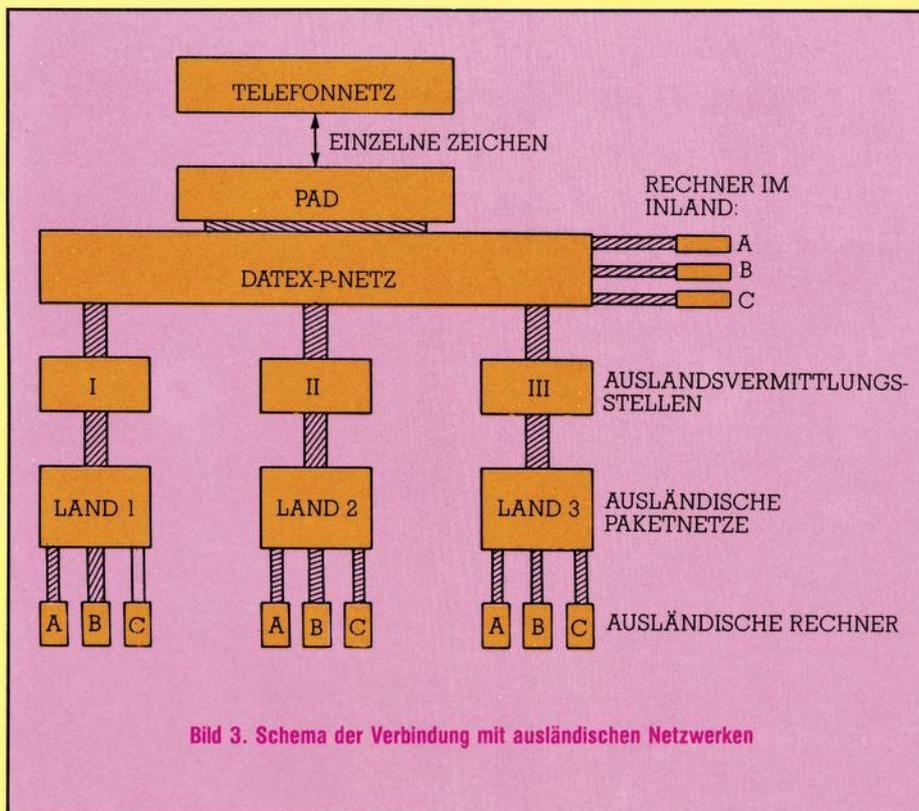
Bild 3. Schema der Verbindung mit ausländischen Netzwerken
