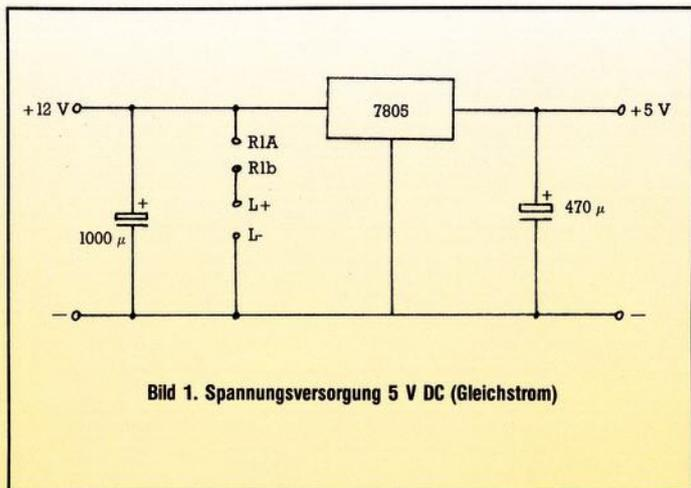
Bild 1. Spannungsversorgung 5 V DC (Gleichstrom)
