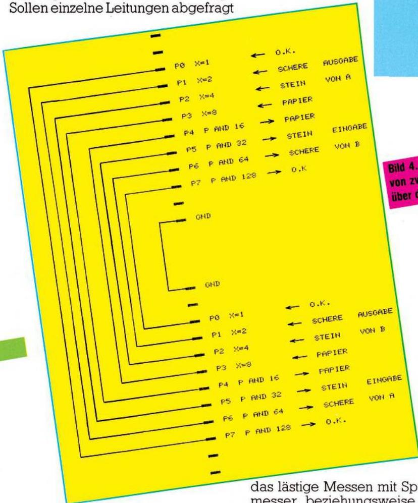
**Bild 4. Kopplung von zwei VC 20 über den Userport**
