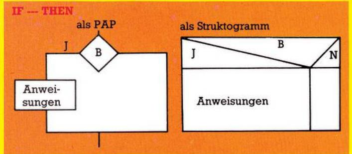
Bild 2. Die Anweisungen werden nur dann ausgeführt, wenn die Bedingung B erfüllt ist. ▲
