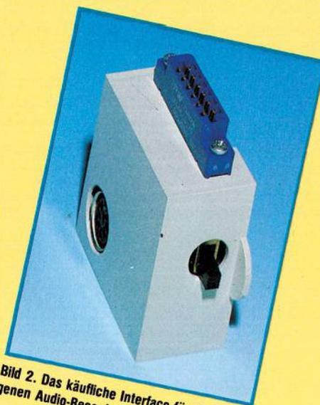
Bild 2. Das käufliche Interface für den eigenen Audio-Recorder
