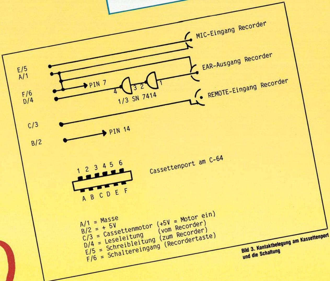
Bild 3. Kontaktbelegung am Kassettenport und die Schaltung
