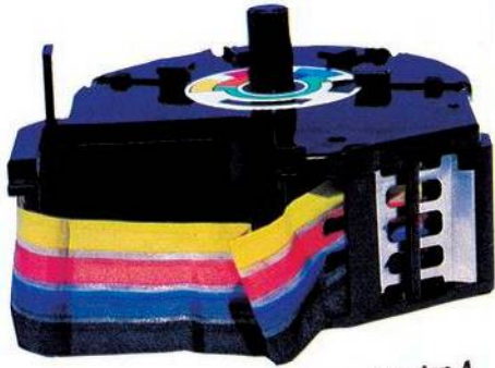
Bild 2. Die Farbbandkassette des GP-700A. Aus den 4 Grundfarben können noch 3 weitere Mischfarben durch Übereinanderdrucken erzeugt werden.
