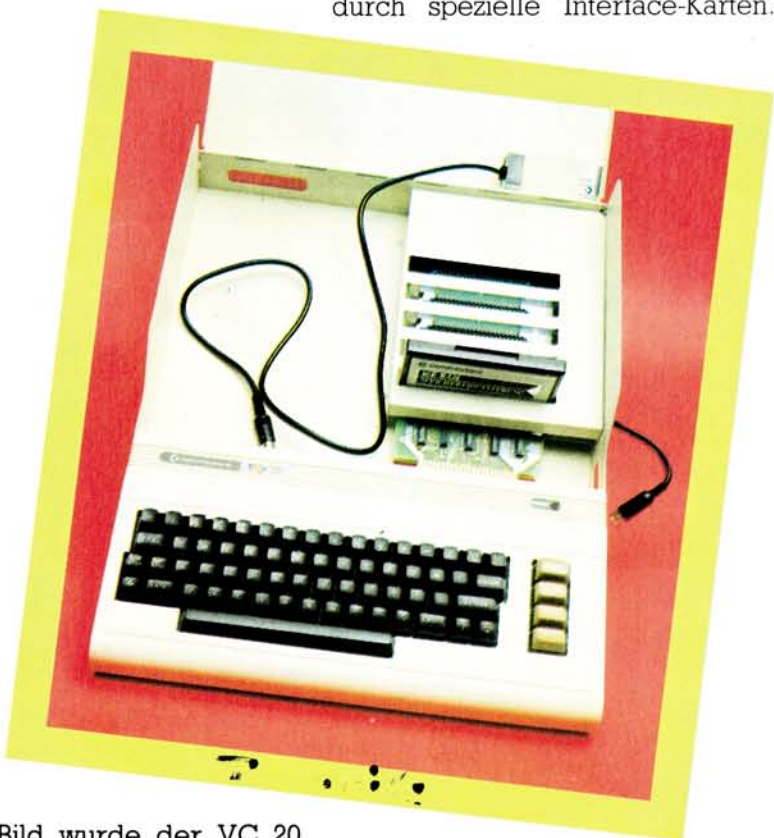
Hier im Bild wurde der VC 20 herausgezogen. Oben rechts erkennt man den HF-Modulator.
