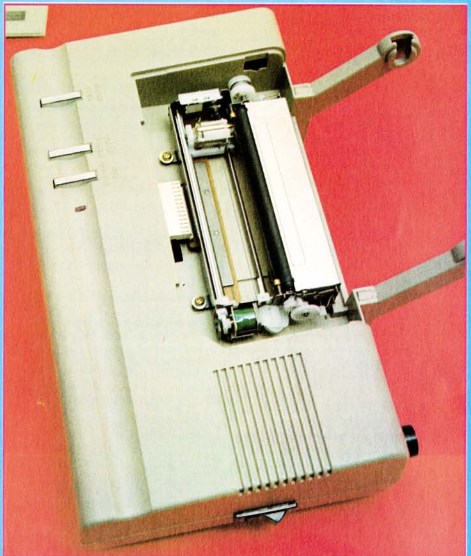
Bild 13. VC 1520. Vorne am Gerät befinden sich drei Druckschalter für Papiervorschub, Farbwechsel und für den Stiftwechsel. Vor der schwarzen Walze sieht man die Trommel mit den kleinen, metallisch glänzenden Farbkugelschreibern. Die beiden Arme an der Rückseite des Plotters nehmen die Papierrolle auf.
