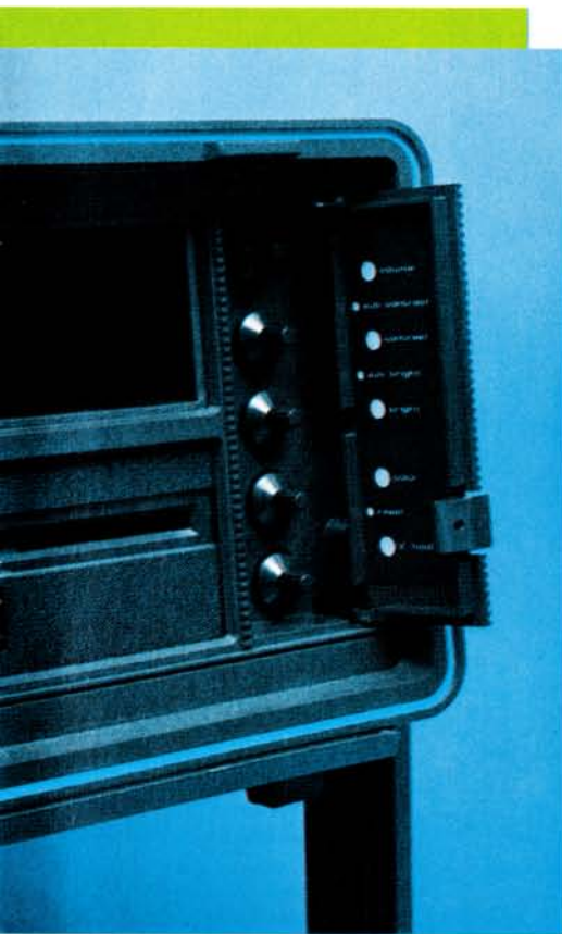
Bild 3. Mit diesen Reglern wird der Bildschirm eingestellt. »Volume« dient zum Variieren der Lautstärke des eingebauten Lautsprechers. Der Resetknopf läßt sich nicht nur mit einem spitzen Gegenstand (etwa Kugelschreiber) auslösen.
